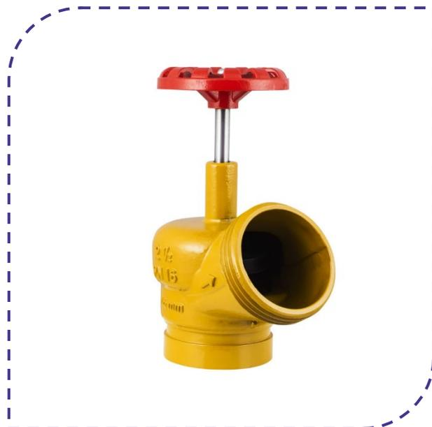
A válvula angular PN 16 ranhurada 2 1/2" fabricada em ferro fundido atende todos os requisitos necessários para as válvulas de hidrante, tendo como benefícios o baixo custo e a elevada robustez, garantindo os mais altos níveis de confiabilidade. Possui um disco de vedação controlado por haste móvel que permite abrir ou fechar completamente a passagem de água.
